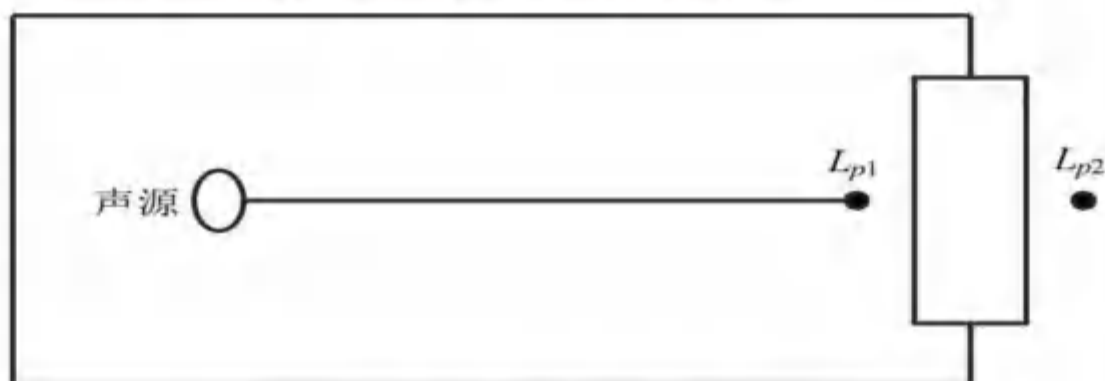
图 4-5 室内声源等效为室外声源图例
