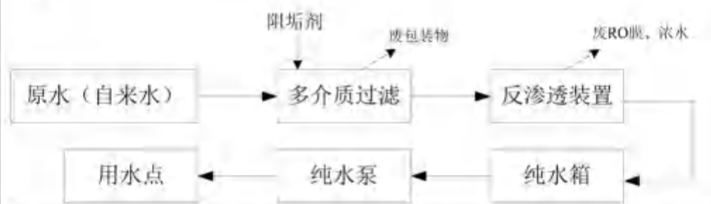
图 2-5 项目纯水制备工艺流程图
