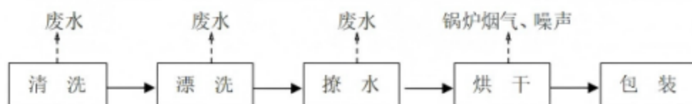
图 2-8 蔬菜制品生产工艺流程及产污节点图
