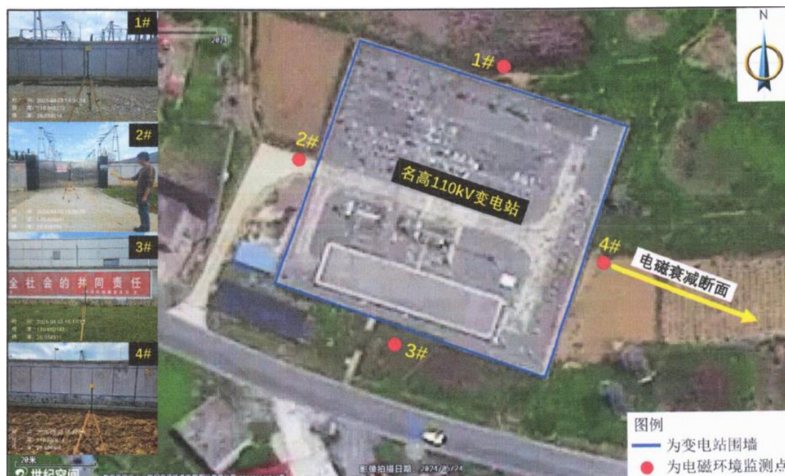
图 8-1 110kV 名高变电站监测布点示意图
