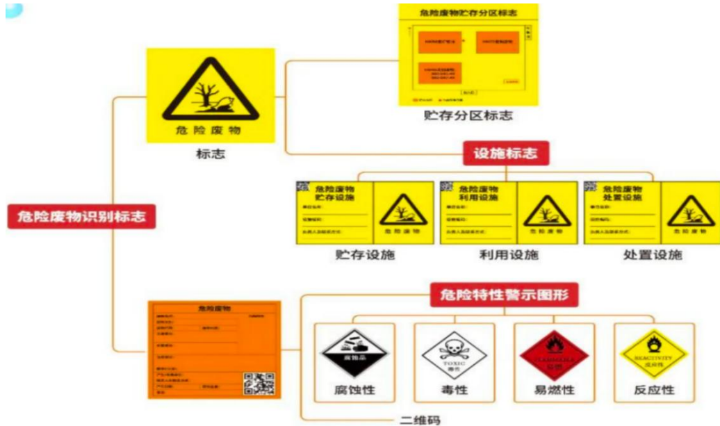
图 4-3 危废暂存间标识牌设置
