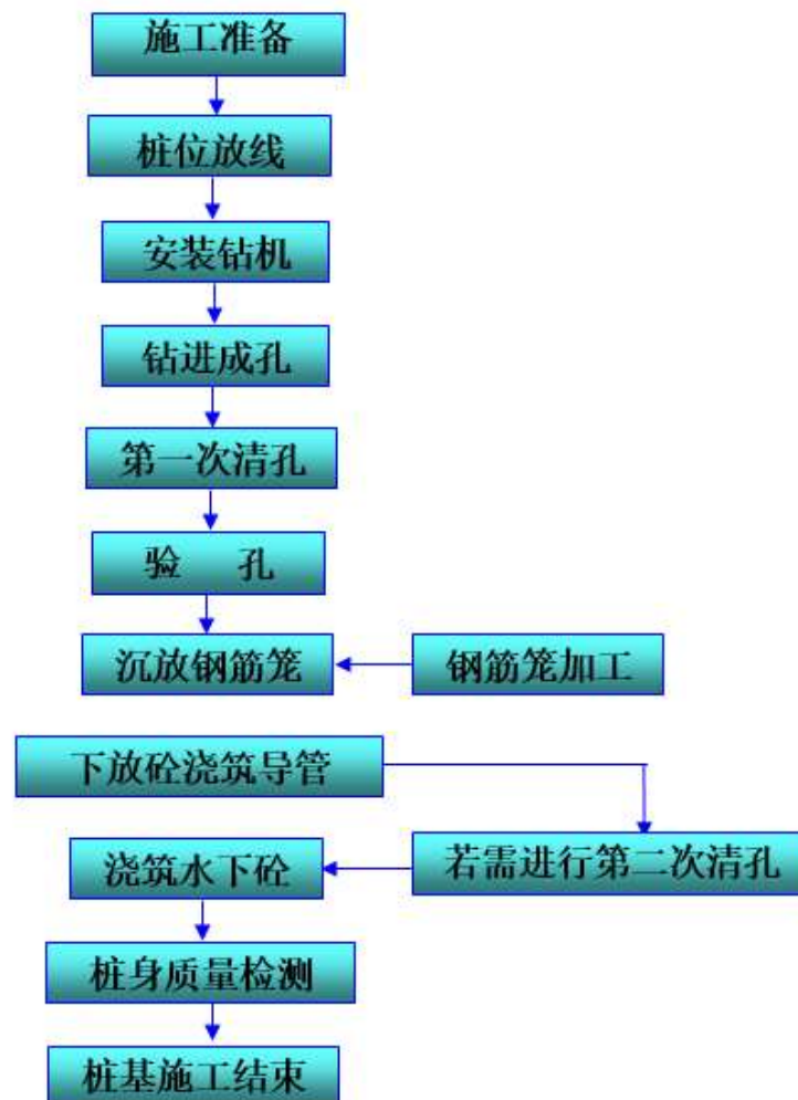
图 2.15-3 灌注桩施工工艺流程图
