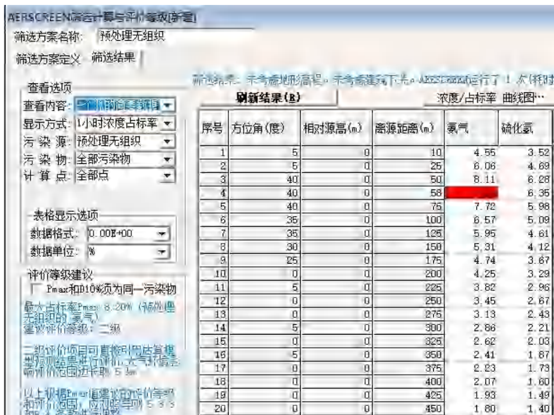
图5.2-3 氨气、硫化氢无组织排放1小时浓度最大占标率结果
