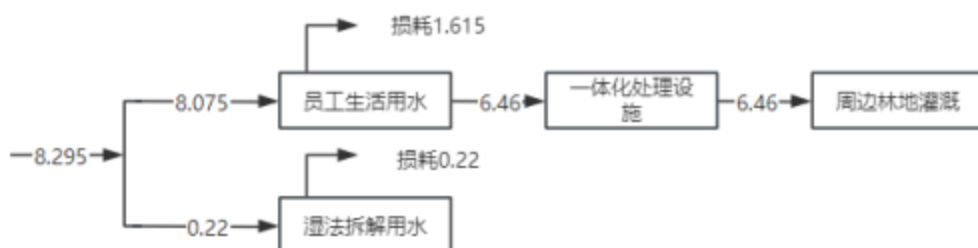
图 3.2-2 扩建完成后全厂水平衡图 (t/d)
