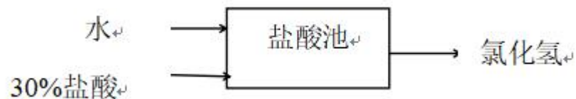
图 2-3 项目配酸工艺流程及产污节点图
