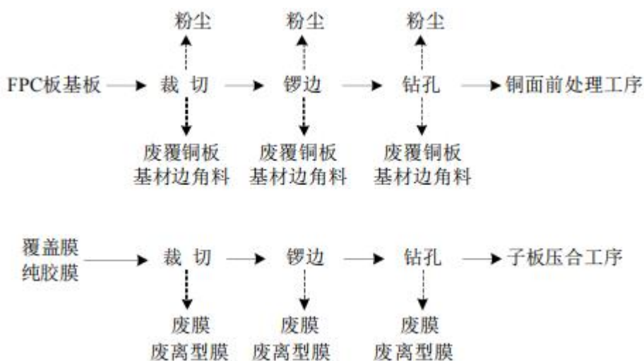
图 2-4 裁板工序工艺流程及产污节点图
