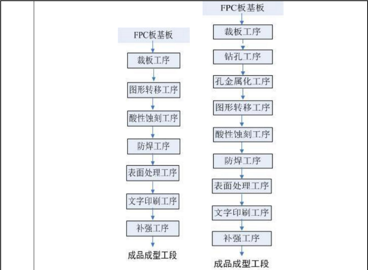
图 2-1 FPC 单（左）/双（右）面板生产工艺流程总图
