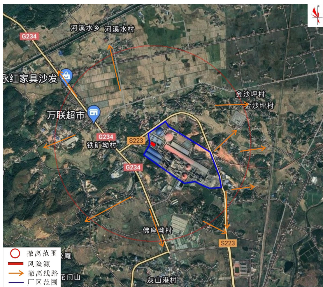
图8.7-3火灾事故下次生污染物情境下的撤离路线图
