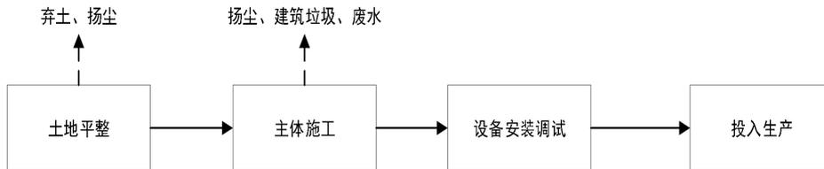
图2 项目施工期工艺流程及产污节点示意图
