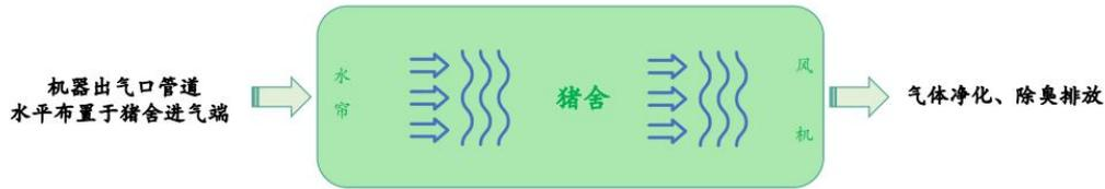
图 7.3-1 项目废气处理工艺图
