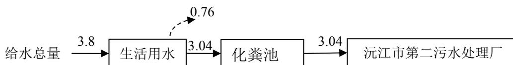
图 3.1-1 项目水量平衡图 单位:m<sup>3</sup>/d
