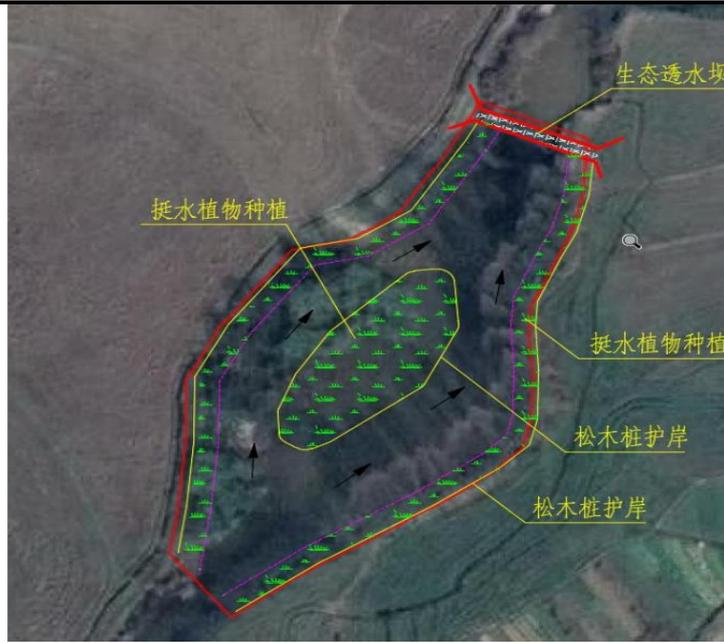
图 2-6 谢林港支渠宽阔水面处进行治疗及生态滞留净化工程平面示意图
