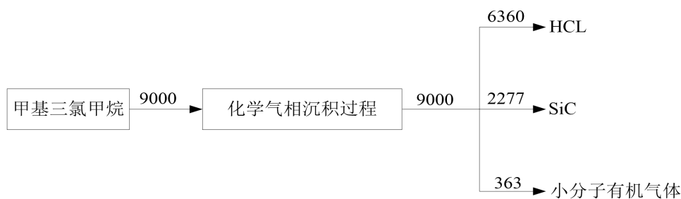
图 2.4-1 全厂甲基三氯硅烷的物料平衡图 单位: kg/a
