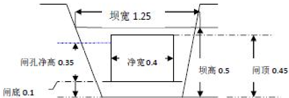
图 3.3-16 节制闸坝断面示意图（单位：m）
