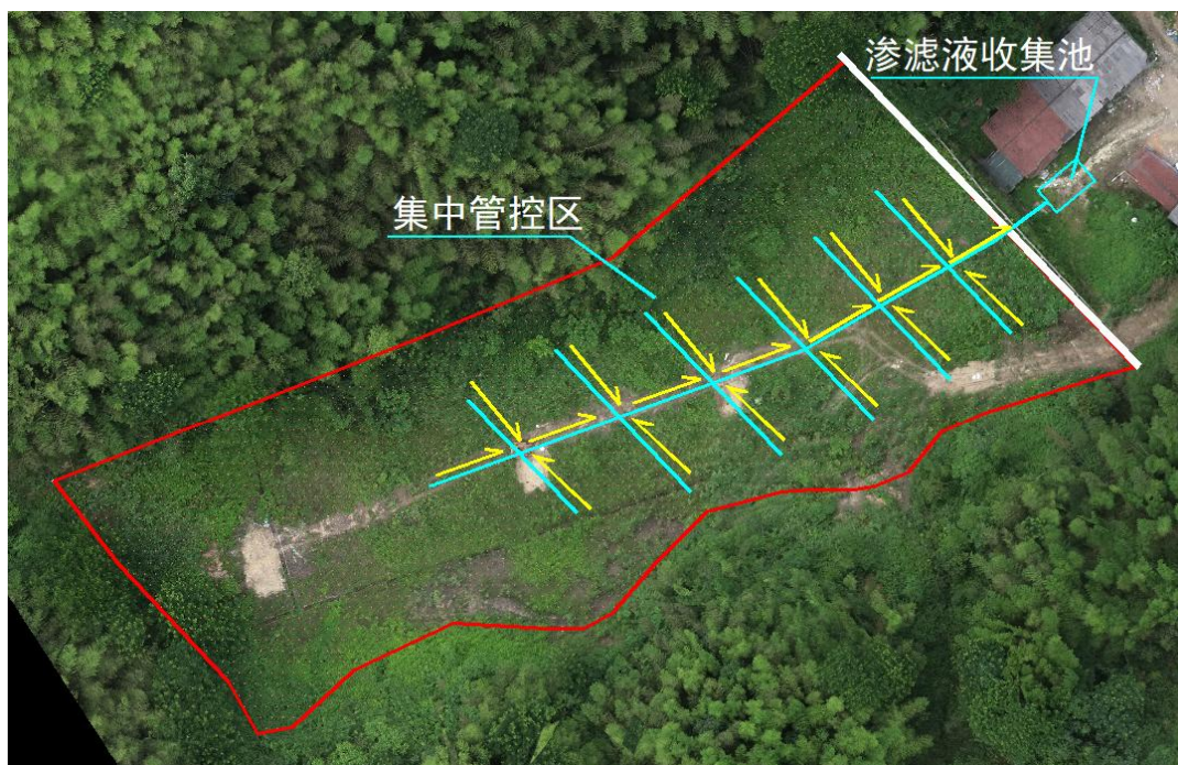
图 3.2-10 渗滤液导排示意图
