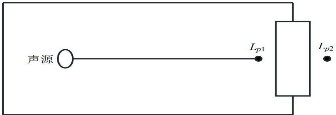
图 4-1 室内声源等效为室外声源图例
