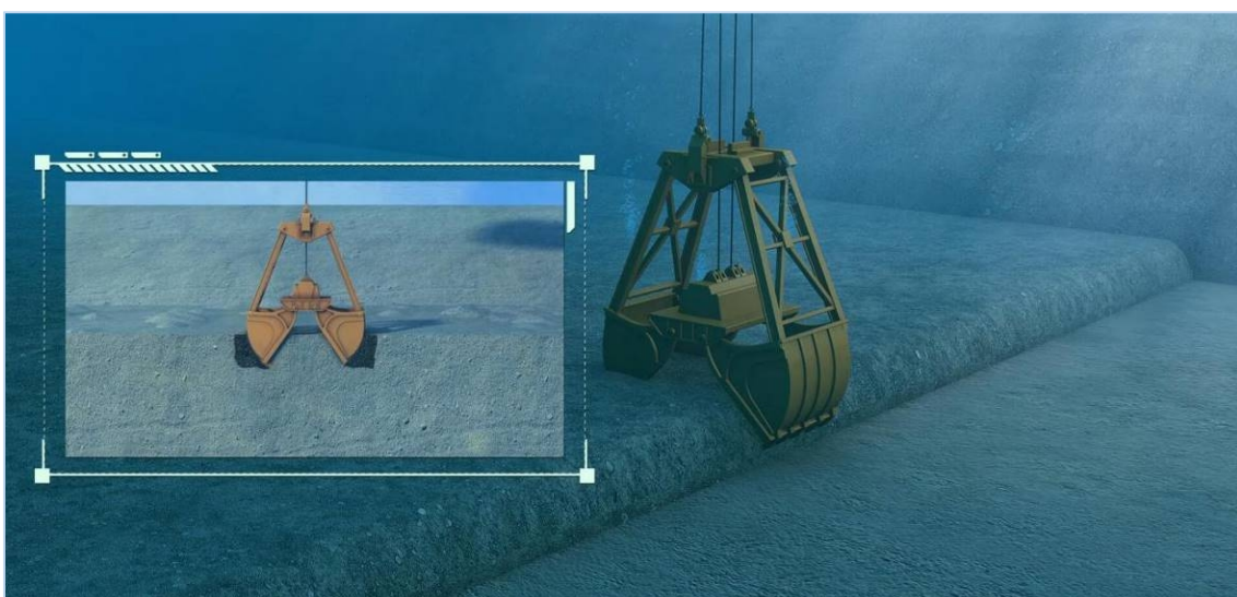
图 2.3-4 抓斗船挖泥示意图
