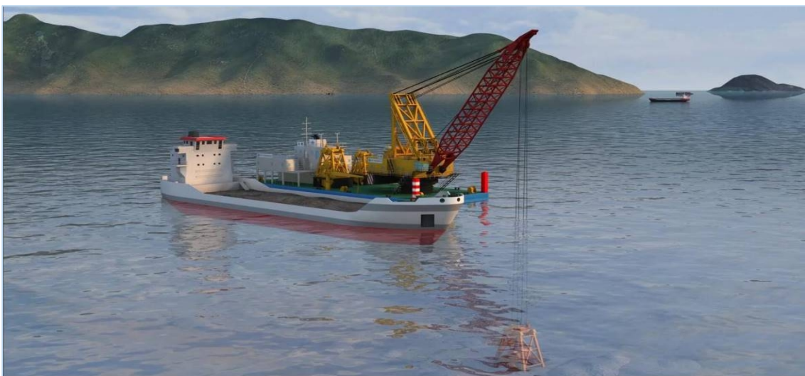
图 2.3-3 抓斗船施工示意图
