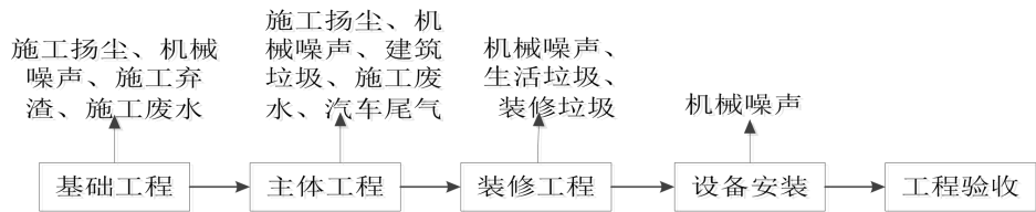
图 2-3 施工期工艺流程及产污环节
