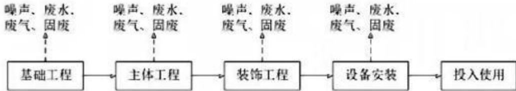
图 2.3-1 施工期工艺流程及产污环节示意图
