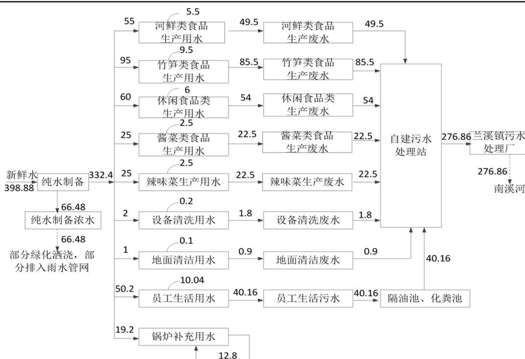
图 2-1 项目淡季水平衡图 单位 (m³/d)
