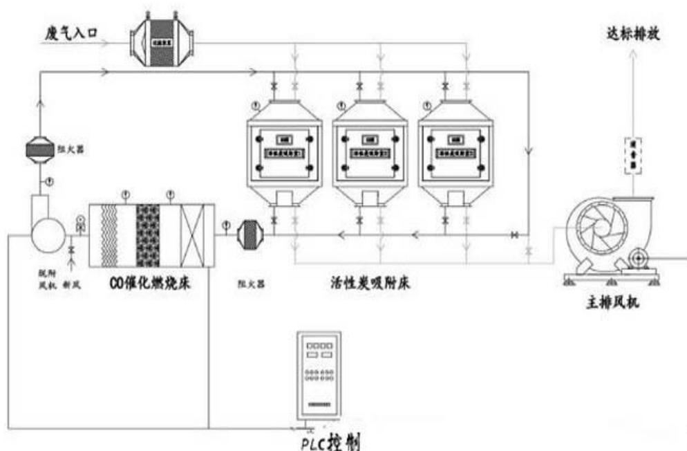
图 6.1-1 吸附脱附+催化燃烧反应原理图
