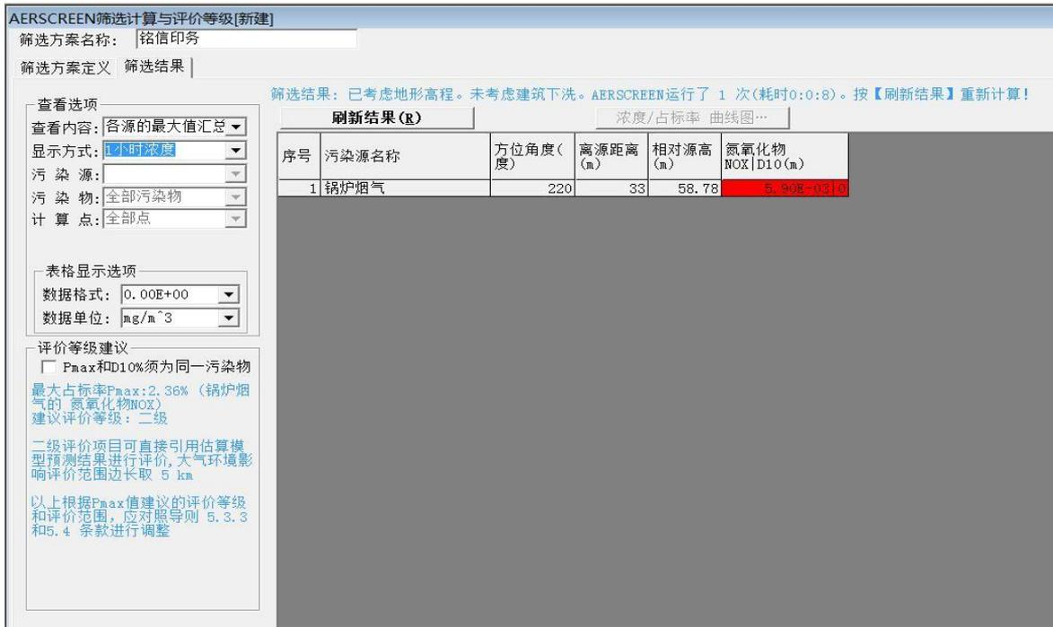
图 5.2-8 正常工况下本项目有组织 NO<sub>x</sub>排放影响预测结果图 (最大值)
