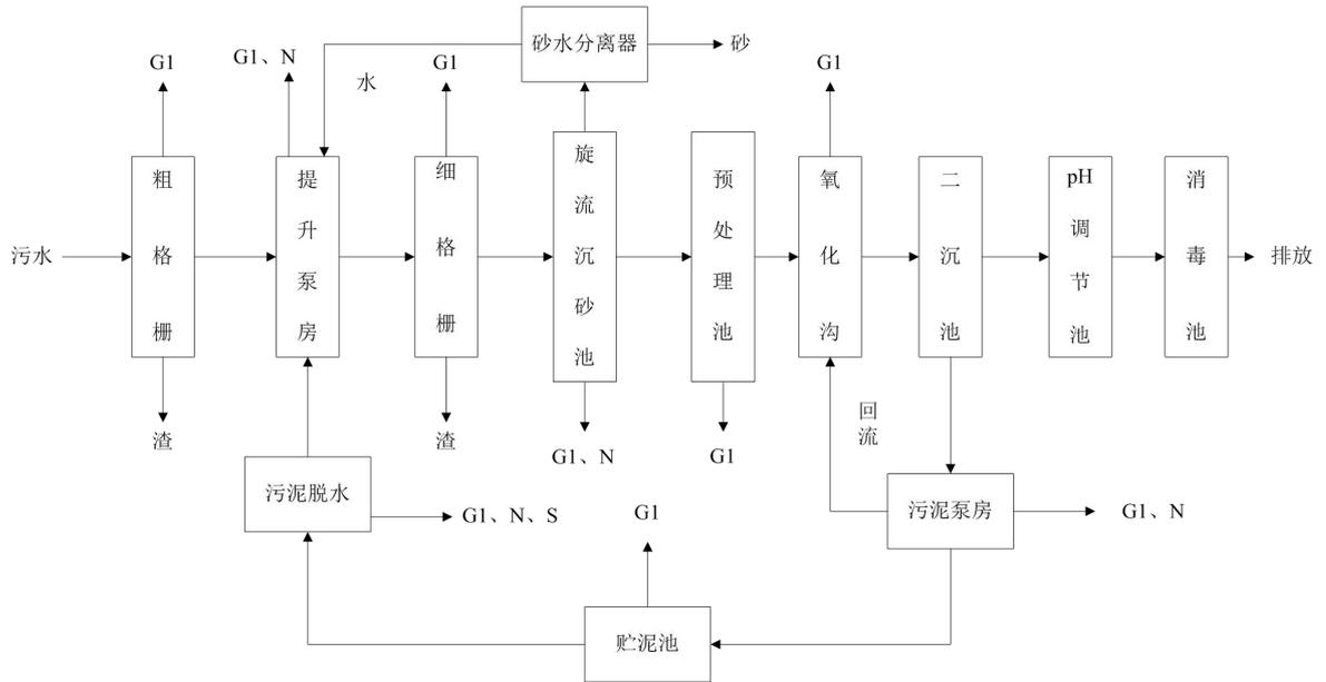
图 4.5-1 污水处理厂污水处理工艺流程图
