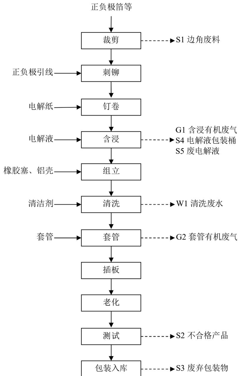
图 2-2 工艺流程及产排污环节图
