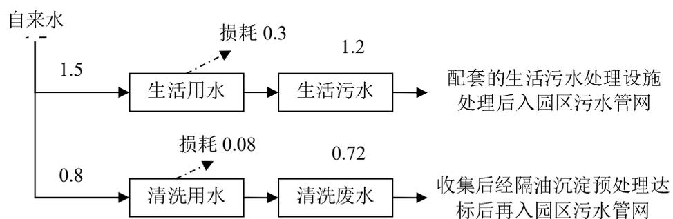
图 2-1 水平衡分析图 ( $\text{m}^3/\text{d}$ )
