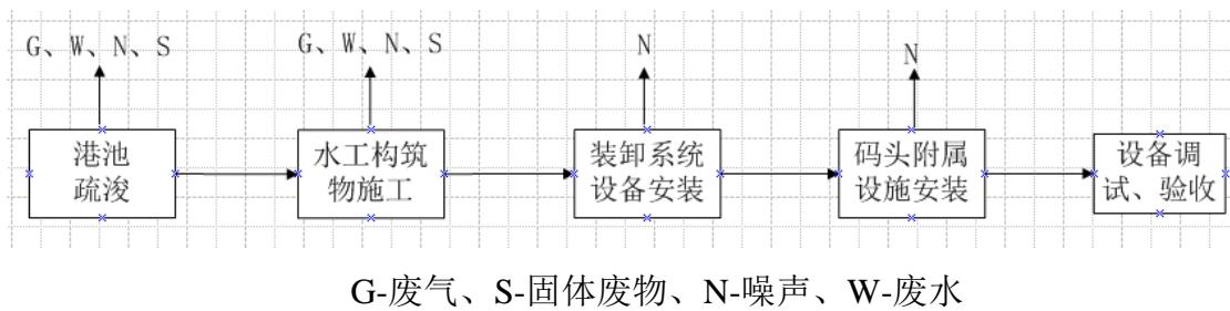
图 3.1-1 施工期主要工艺流程和产污环节图
