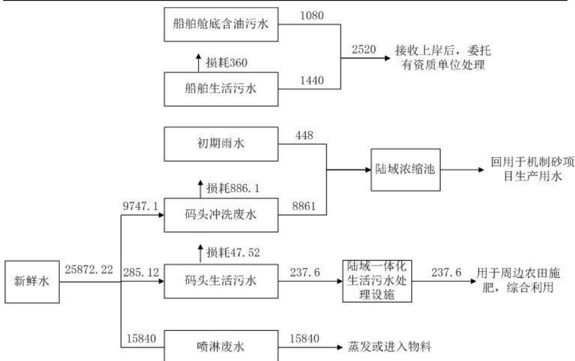
图 3.4-1 本项目水平衡图(单位: m<sup>3</sup>/a)
