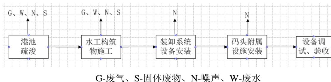
图 3.1-1 施工期主要工艺流程和产污环节图
