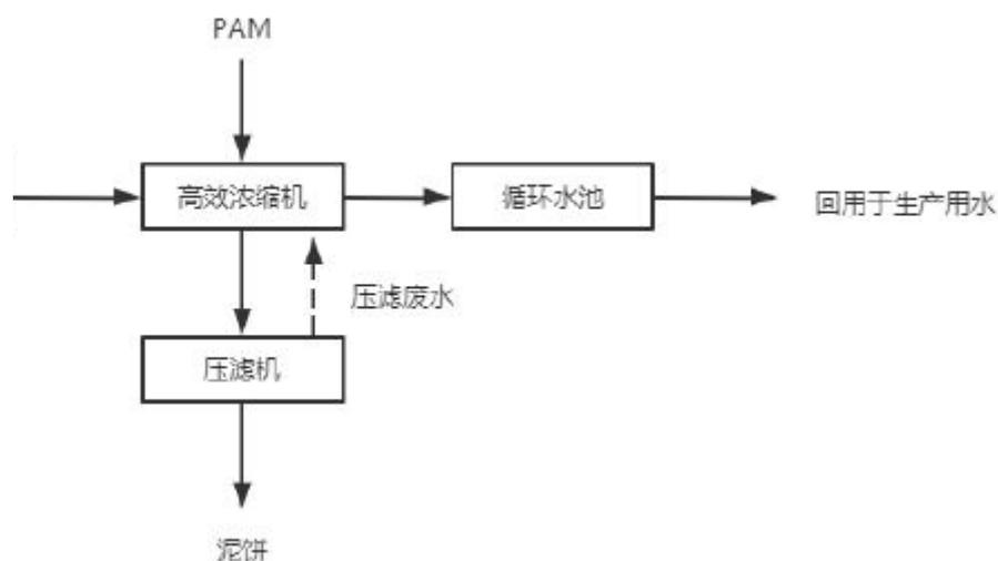
图 8.2-1 生产废水处理工艺流程
