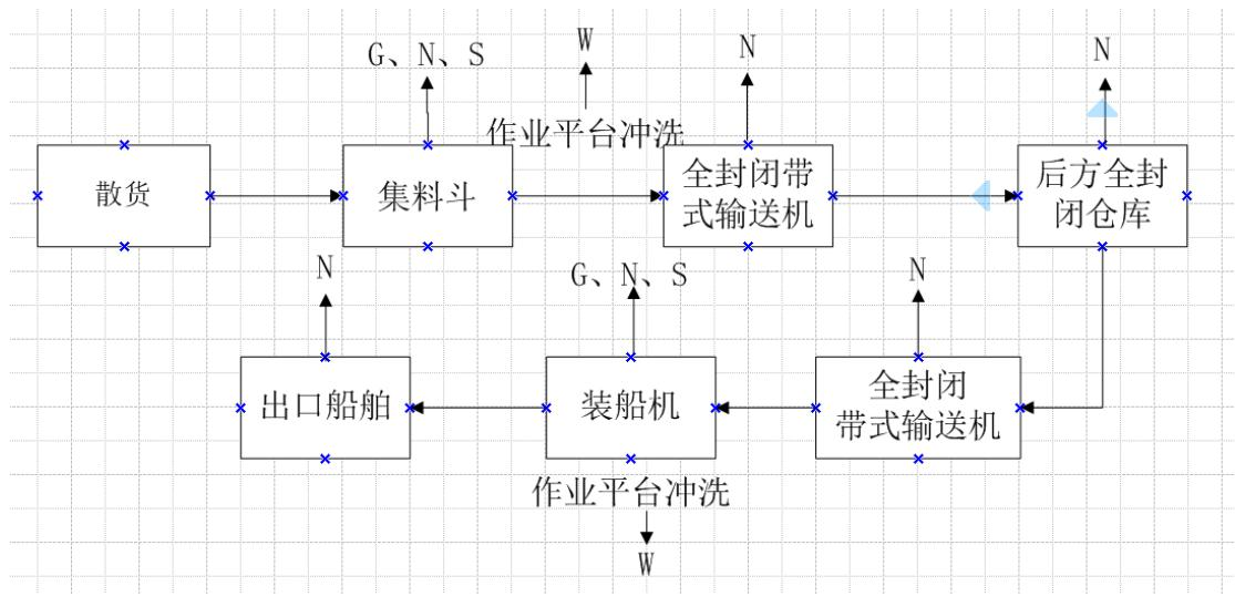
G-废气、S-固体废物、N-噪声、W-废水
