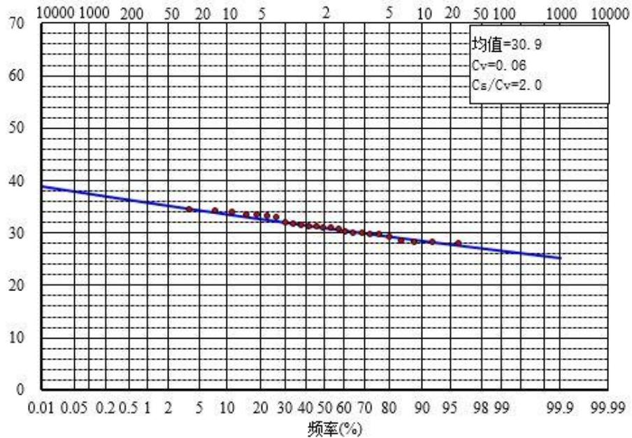
图 5.1-2 鹿角站设计洪水累积频率曲线
