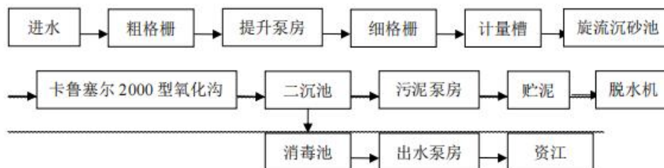
图 4-1 城北污水处理厂污水处理工艺流程图
