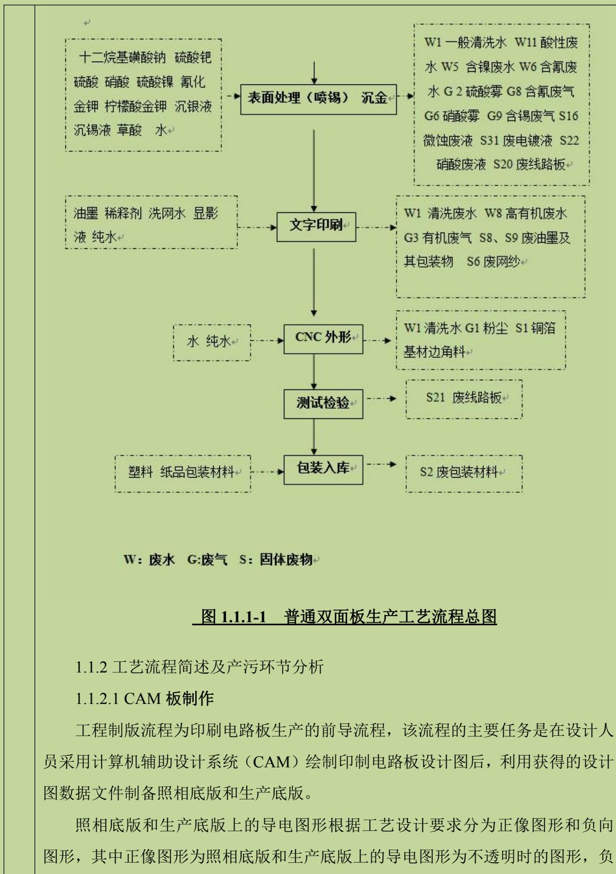
**图 1.1.1-1 普通双面板生产工艺流程总图**
