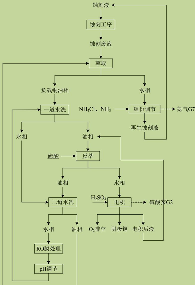
图 1.5.3-1：碱性蚀刻废液循环系统工艺流程及产污节点图
