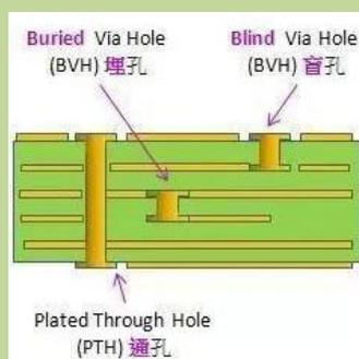
图 1.1.2-3：埋孔结构示意图
