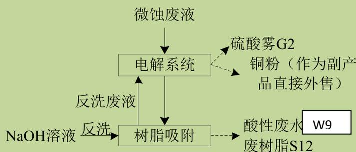
图 1.5.4-1：微蚀废液铜回收工艺流程及产排污节点图
