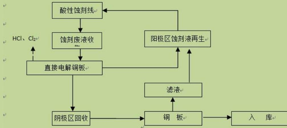
图 1.5.2-1：酸性蚀刻废液循环系统工艺流程及产污节点图
