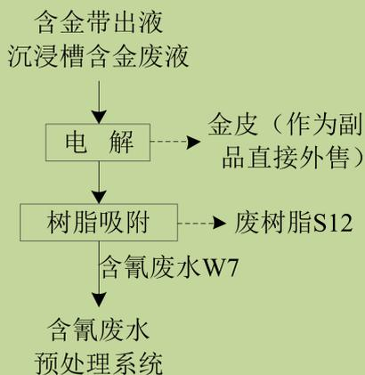
图 1.5.5-1: 含金废液/废水金回收系统工艺流程及产污节点图
