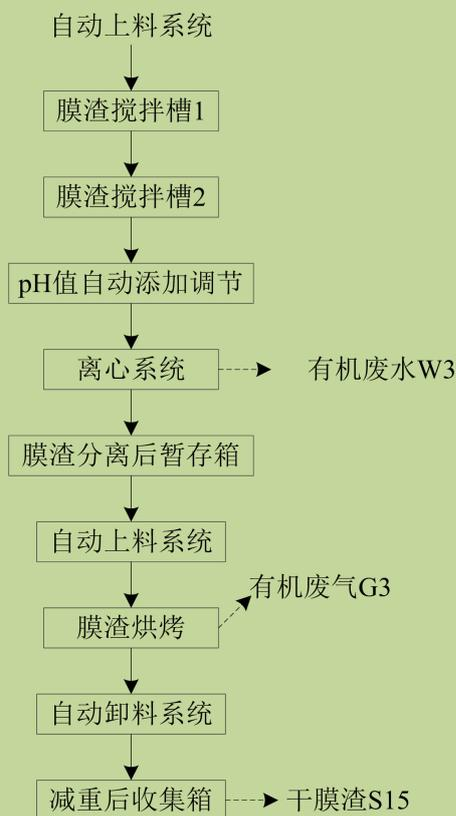
图 1.5.7: 干膜渣减重工艺流程及产排污节点图
