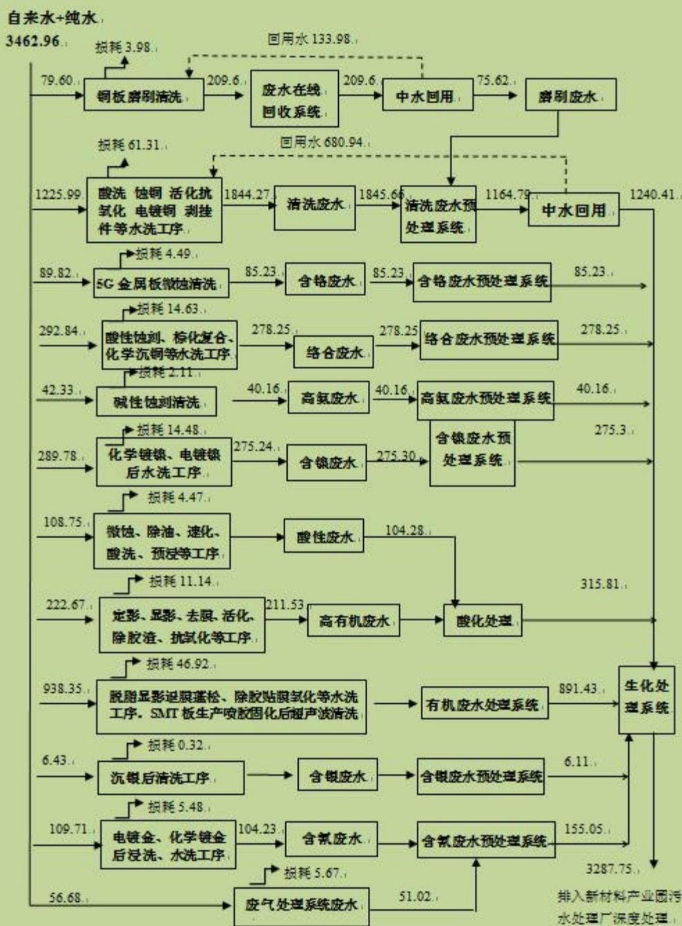
图 2-1 生产工艺水平衡图 (m³/d)
