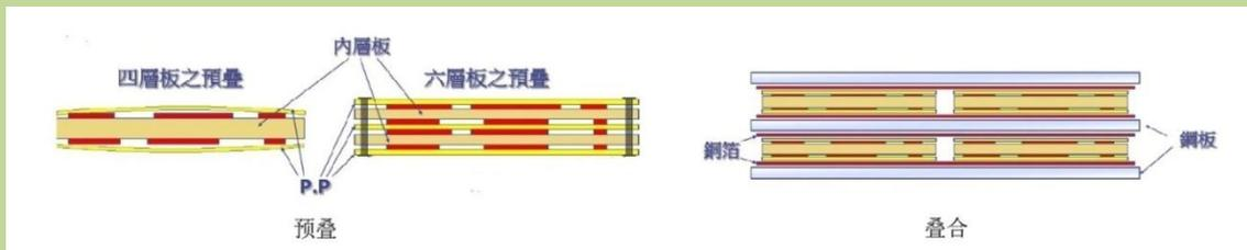
图 1.1.2-2 预叠和叠合结构示意图
