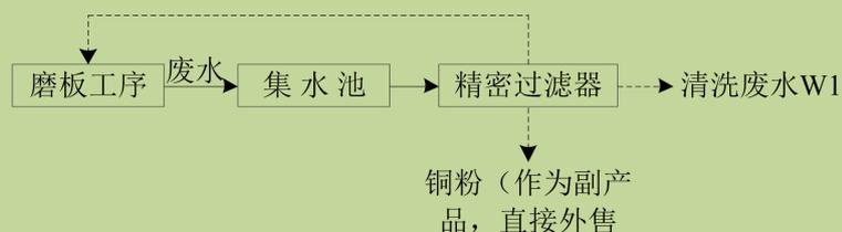
图 1.5-1：刷磨废水在线回收铜粉工艺流程及产污节点图
