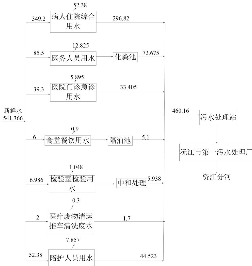
图 4.2-3 本扩建项目水平衡图 单位: m³/d
