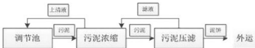
图 3.3-6 规范推荐的重金属污水污泥处理工艺
