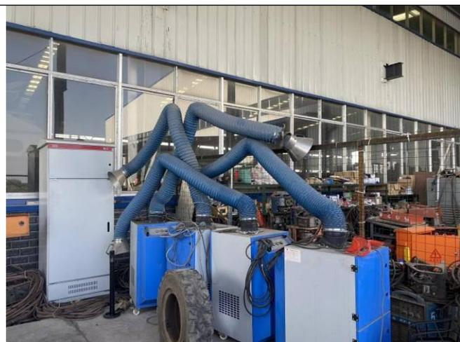
移动式焊接烟尘净化器
