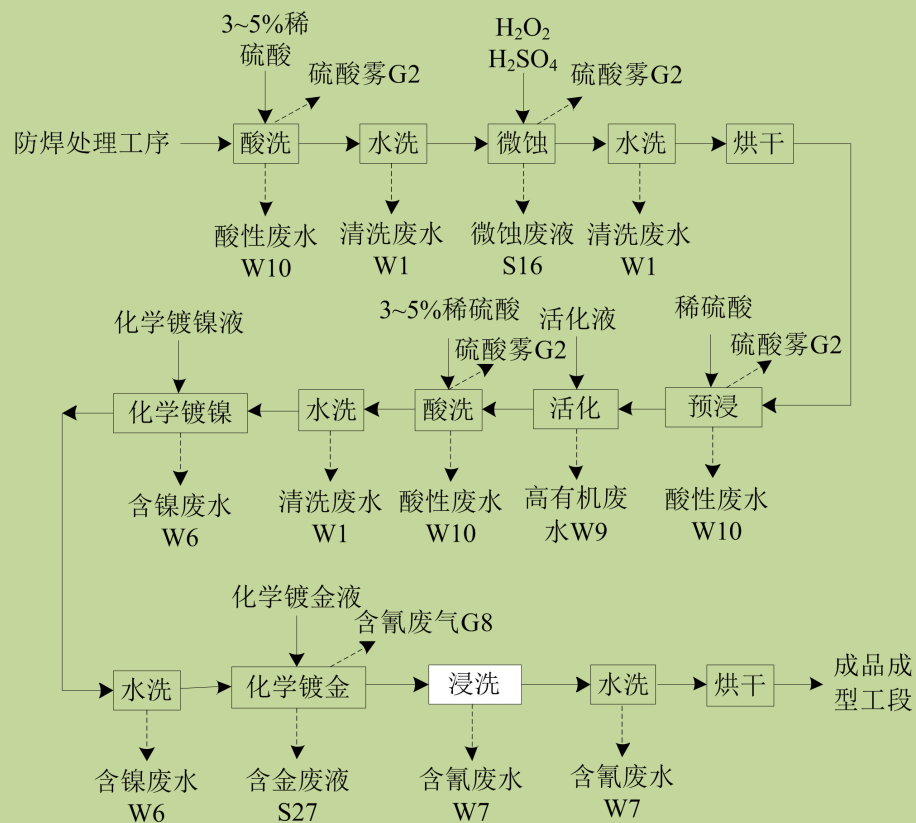
图 1.1.2-21：化学镀镍金操作单元生产工艺流程及产污节点图
