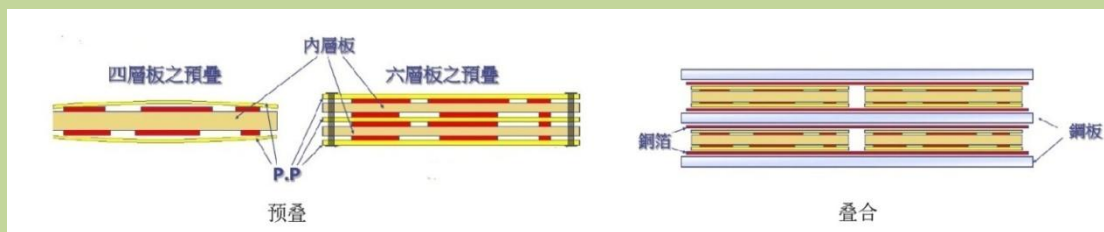
图 1.1.2-8 预叠和叠合结构示意图
