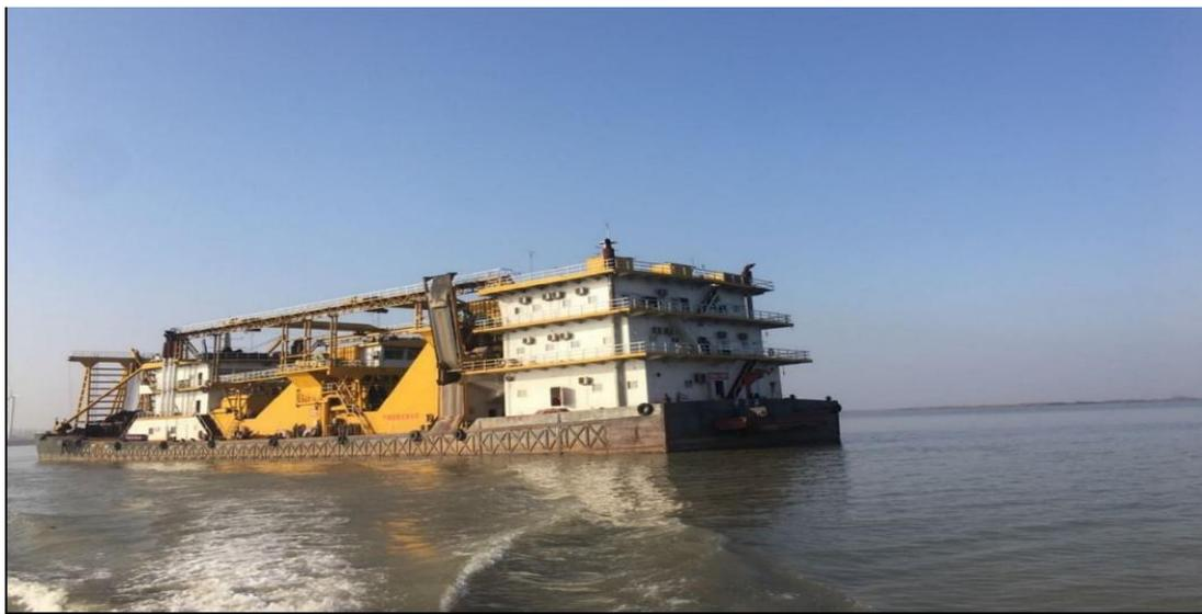
图 4.1-1 吸砂泵式采砂船
