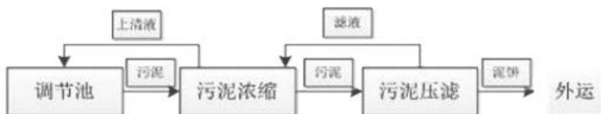
图 3.3-2 污泥处理工艺流程
