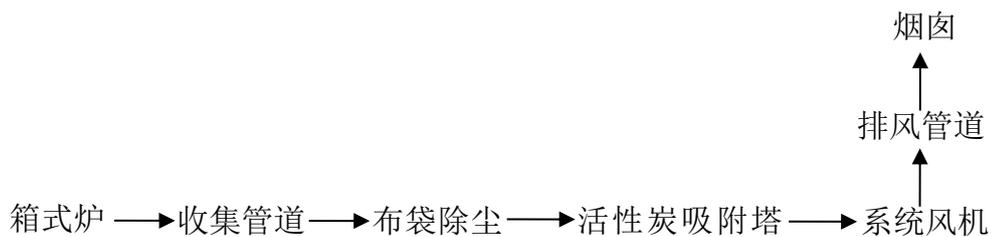
图 4-1 焙烧烟气处理工艺流程
