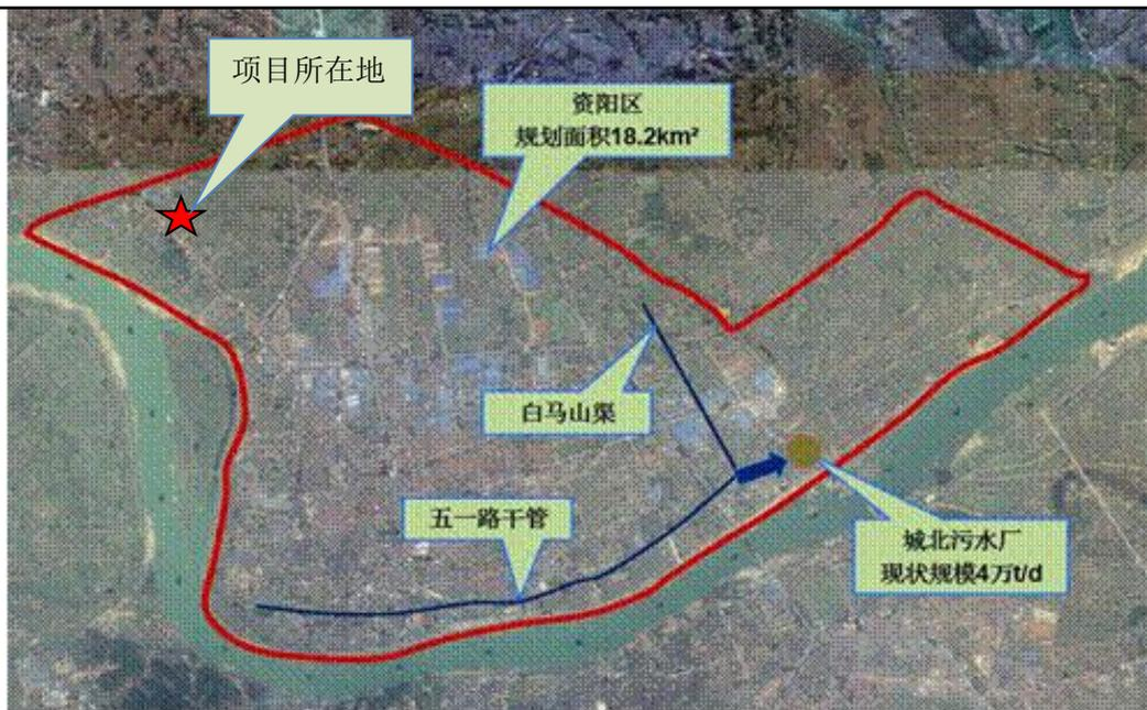
图 4-4 城北污水处理厂管网现状及服务范围示意图
