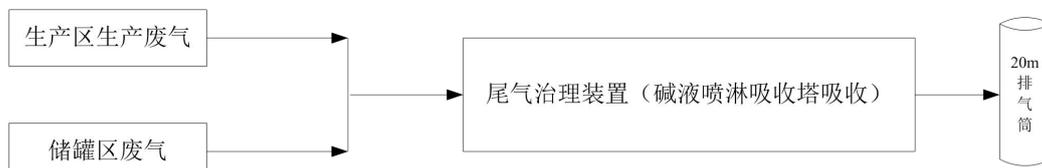
图 4-1 废气治理流程图
