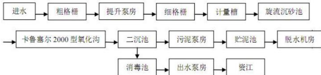
图 2-1 城北污水处理厂污水处理工艺流程图
