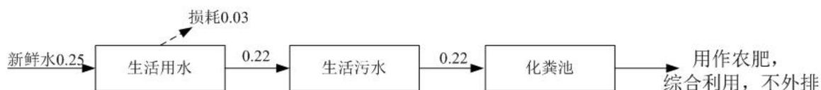
图 1-2 水平衡图 (单位: m<sup>3</sup>/d)
