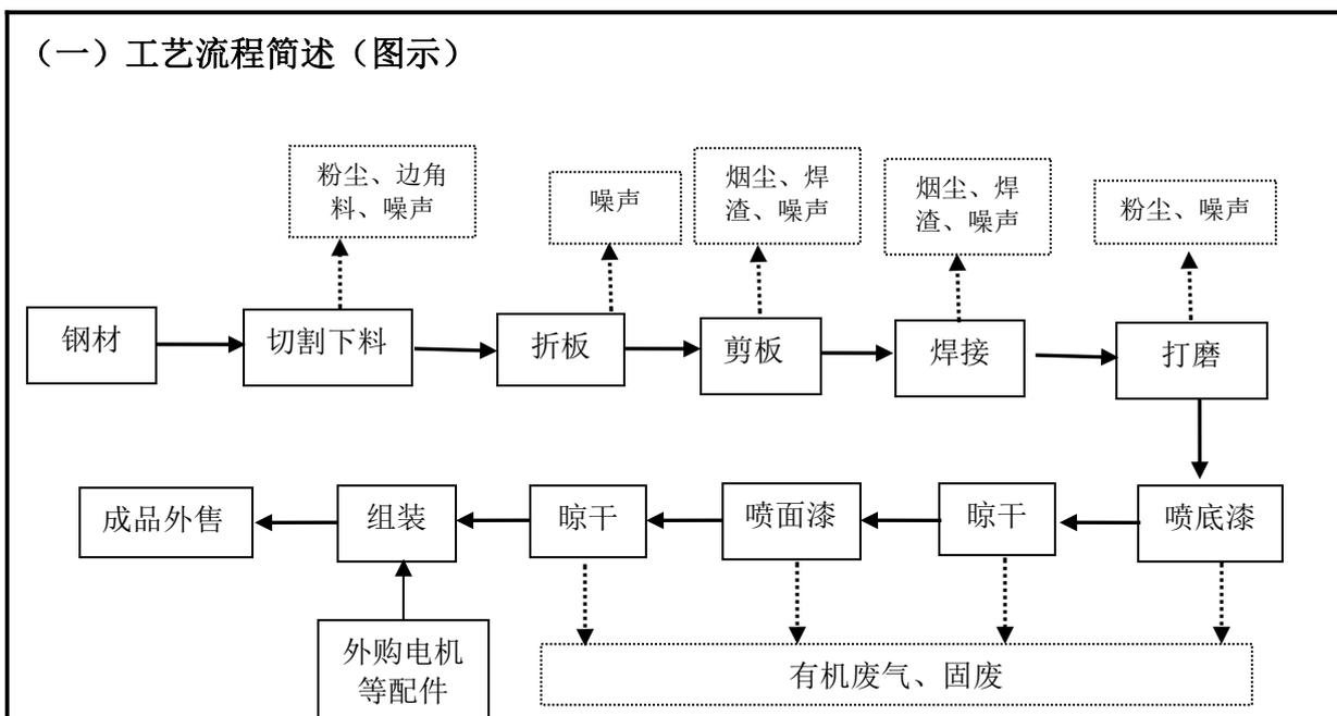
图 4-1 印刷机生产工艺流程及产污节点图
