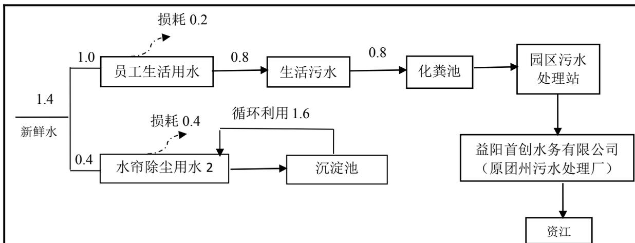
图 1-1 建设项目水平衡图 (t/d)
