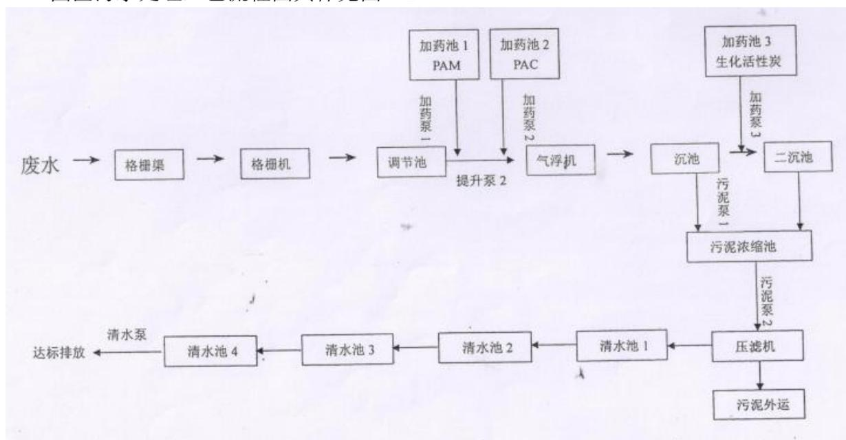
图 6-1 园区污水处理站工艺流程图
