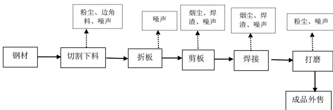
图 4-2 硫化机零配件加工工艺流程及产污节点图
