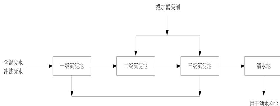
图 7-2 废水处理工艺流程图
