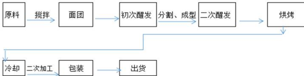
图 4-1 面包加工生产线工艺流程
