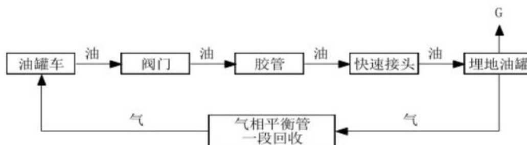
图 4-1 卸油工艺及污染流程图（G 表示废气）
