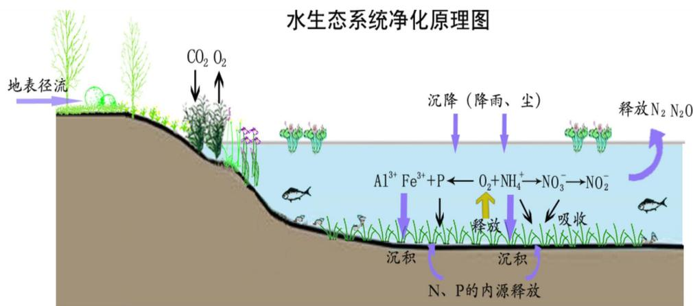
说明：水生态修复是有效控制和预防水体富营养化的根本途径。利用“食藻虫”引导水下生态修复技术，打通食物链，恢复完整的水下生态系统。修复系统消除水体中过多氮磷等富营养化物质的基本途径：
