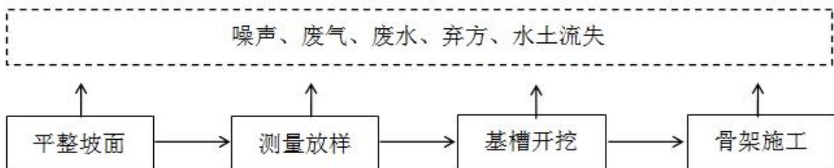
图 5-2 边坡、路基排水施工工艺流程及产污环节
