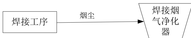
图 7-1 焊接废气治理措施工艺流程图
