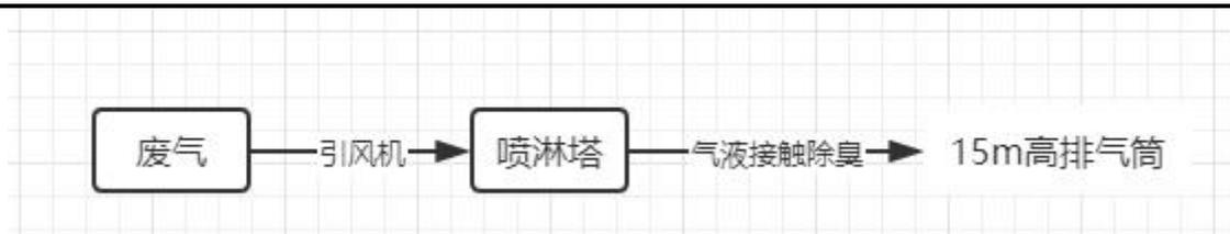
图 7-1 废气处理流程图
