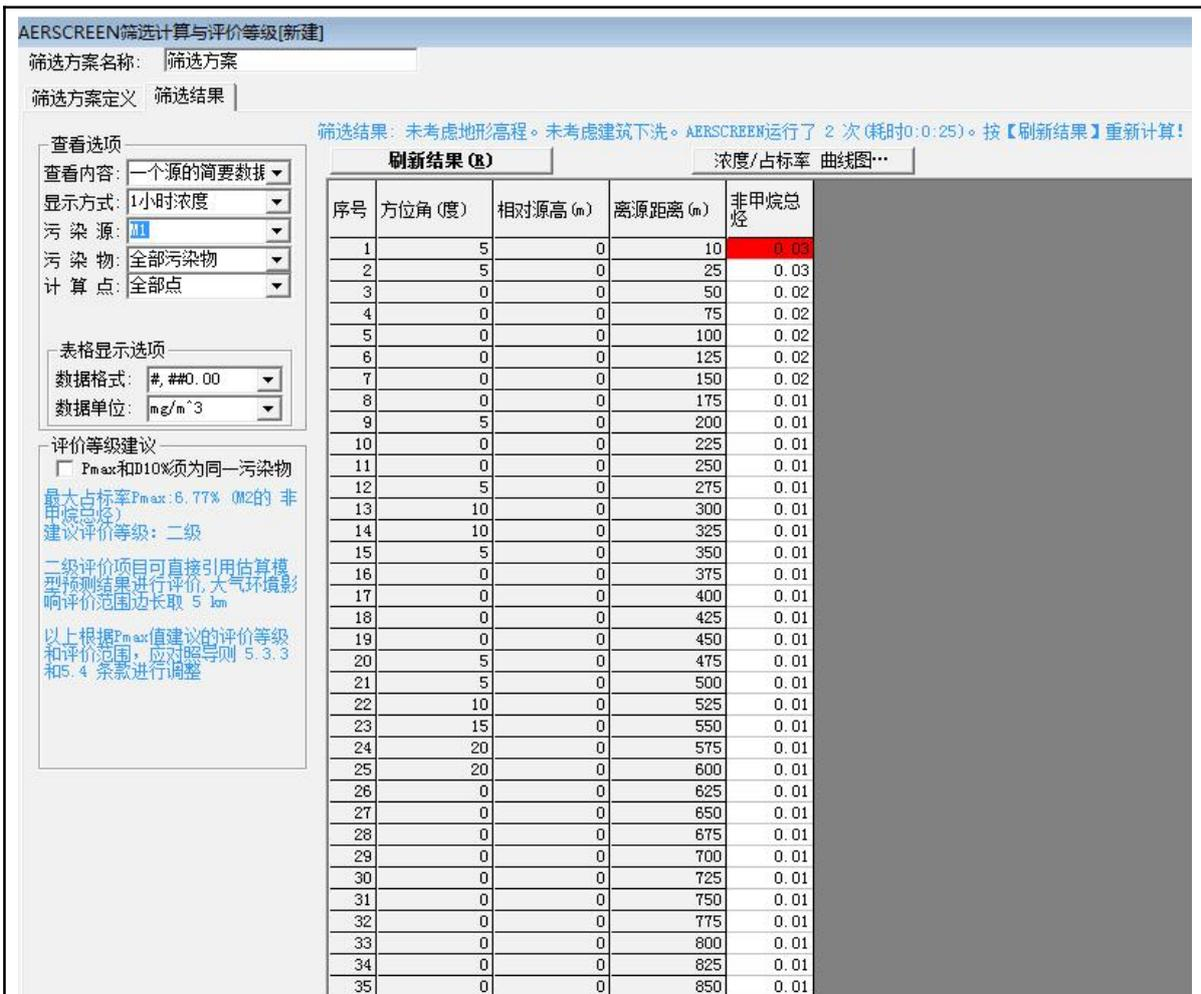
图 7-3 M1 无组织废气(非甲烷总烃)预测截图
