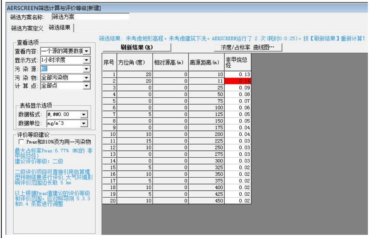
图 7-4 M2 无组织废气(非甲烷总烃)预测截图
