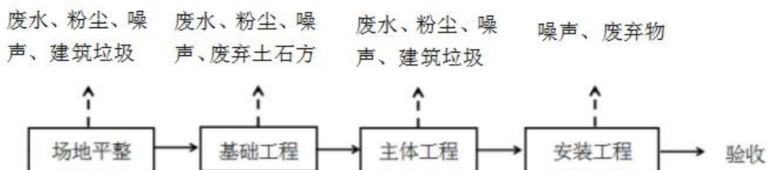
图 5-1 项目施工期工艺流程图
