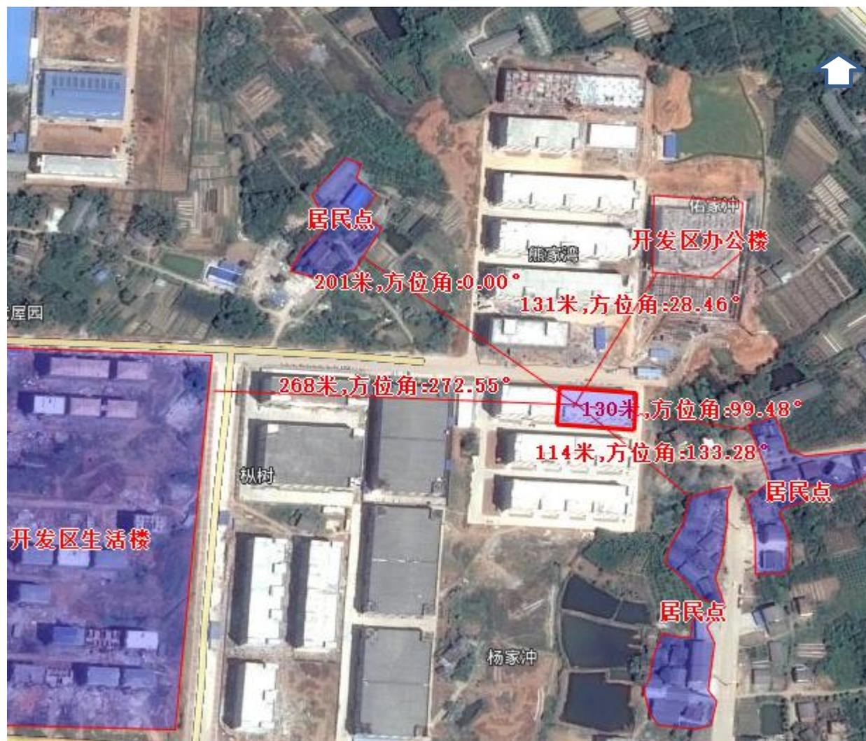
从敏感目标的分布来看，以项目混料搅拌区为中心，东北侧开发区办公楼和东侧居民点距离项目较近且处于开放区域，较容易受到项目噪声影响，项目主要设备的布置应尽量排放在距离此两个区域较远的位置。环评要求项目将空压机、真空泵及新风机尽量布置在项目西侧区域。
