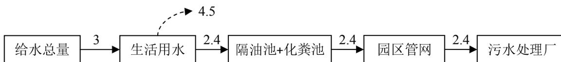
图 1-1 项目水量平衡图 单位:m<sup>3</sup>/d
